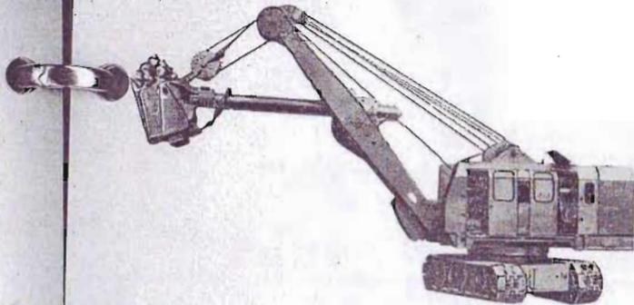
Der B 323 ist der größte Bagger der Einmotorenserie. Er wird eingesetzt bei allen schweren Arbeiten im Bauwesen, im Fels, in der Schlacke und bei großräumigen Erdbewegungen. Verwendet wird
