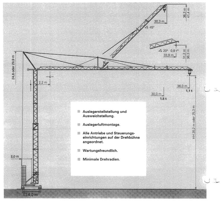
\* Bei Steilstellung verfahrbare Laufkatze mit konstanter Tragkraft 0,8 t.
