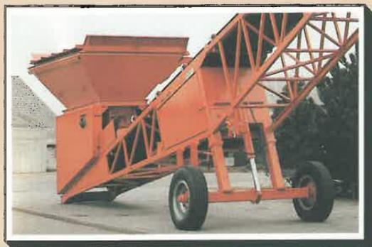
Der **Trichter**, mit ca. 7 m<sup>3</sup> Fassungsvermögen, ist so konstruiert, daß kein Material an dessen Wänden anbacken kann. Die Beschickungsbreite ist mit 3,85 m groß genug, um auch mit einem großen Radlader arbeiten zu können.
