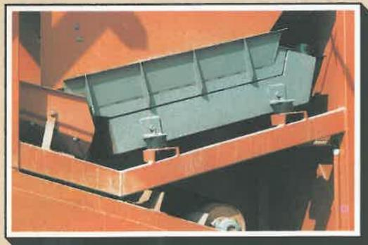
wahlweise Die regelbare **Vibrorinne** ist ein Austragungsorgan, welches gerne bei Schuttverarbeitung und gut fließenden Schüttgütern eingesetzt wird.
