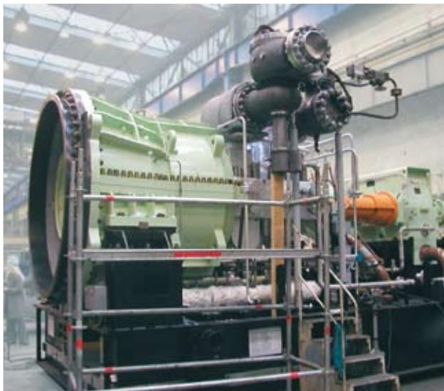
Турбина SST-300, предназначенная для привода генератора, находит применение в таких областях как:
