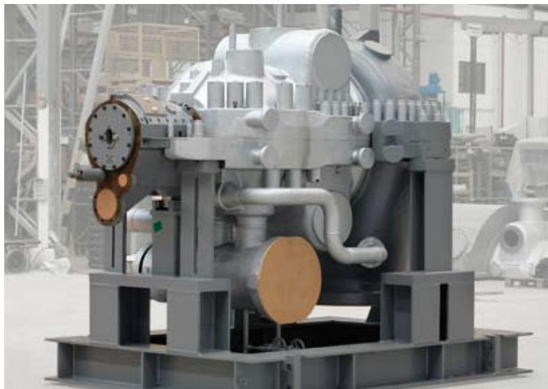
**SST-300:** Турбина с противодавлением мощностью 26 МВт, установленная на заводе по производству сахара и этилового спирта в Бразилии
